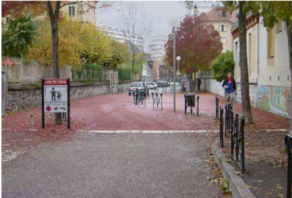
**Chicane posta su una piattaforma e realizzata mediante l'allargamento dello spazio pedonale con transenne**
